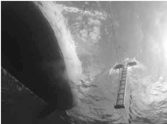
Abb. 8/9 Multi-Level-Schleppnetz und Luftaufnahmen treibender Objekte zur dreidimensionalen Kartierung von Müllpartikeln im GPGP durch The Ocean Cleanup
