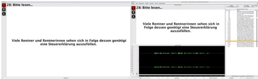
**Abb. 8.4:** SpeechRecorder Sprecheransicht (links) und Aufnahmeleiteransicht (rechts). In der Aufnahmeleiteransicht sind zusätzlich ein Oszillogramm zur Beurteilung des Mikrofonpegels sowie die Liste aller schon aufgenommenen bzw. noch ausstehenden Aufnahme-Items zu sehen.
