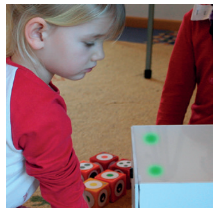
Abbildung 5: Paarweise zusammenzulegende, farbige Kunststoffwürfel mit integrierten Lagensensoren und Funkmodul zum gemeinsamen Programmieren und weiße Box mit zentralem Controller, Funkmodul, LED-Anzeigen und Sumner. Ein entfernter Ablageort für Bausteine befindet sich am Ende des Raums im Bildhintergrund.
