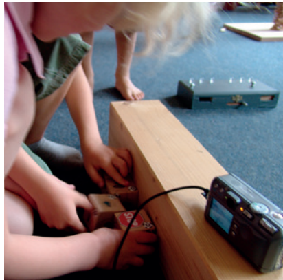
Abbildung 4: Gemeinsames Programmieren mit Holzwürfeln auf denen Topcodes via Kamera erfasst werden können, die an einen Laptop angeschlossen ist. Dahinter die Box zur Ausgabe des Codes mit zwei Mikrocontrollern, LEDs und Sumner. Die Fläche zur Ablage von Bausteinen befindet sich am Ende des Raums im Bild rechts oben.
