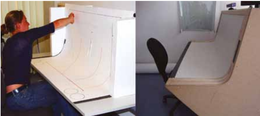
Abbildung 1: Links: Eine Studentin interagiert mit dem Papierprototyp während der Entwicklung des Curve (Wimmer 2009). Rechts: Finale Konstruktion des Curve basierend auf einer gebogenen Plexiglassplatte.
