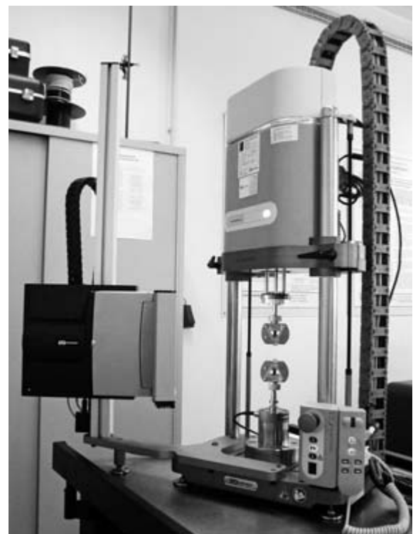
Bild 3. Prüfmaschine Instron ElectroPuls E1000
