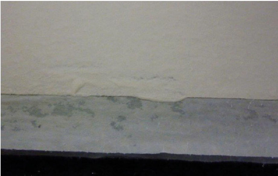
Abb. 12: Gautschfehler Überdehnung bei frisch geschöpftem Papier aus der Werkstatt von Johannes Follmer
