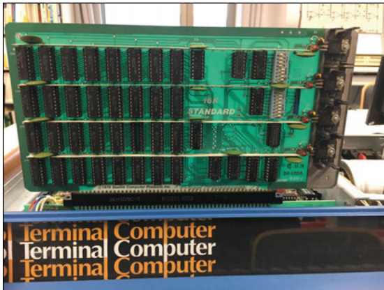
Abb. 11: Zu Testzwecken kann eine Karte von oben in den S-100-Bus gesteckt werden. Hier wird die scheinbar defekte RAM-Karte getestet.
