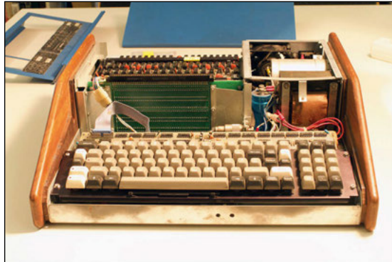
Abb. 5: Der geöffnete Sol-20.
