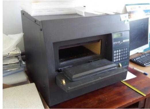
**Fig. 4.** Heat Flow Meter Netzsch
