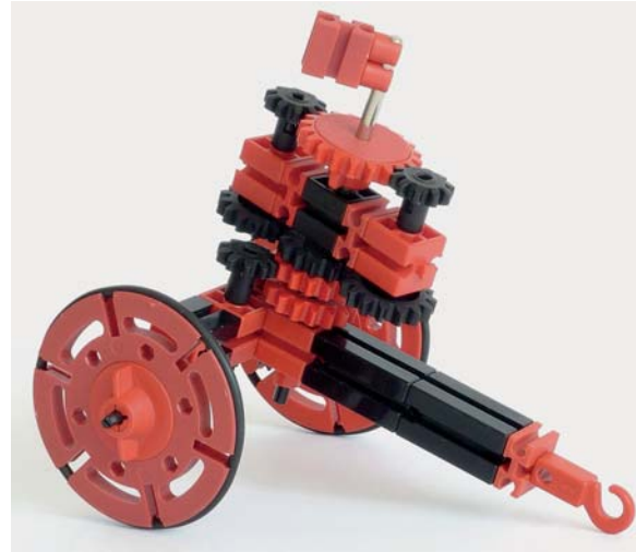
Abbildung 7. Kompasswagen zur Verdeutlichung und Erklärung des Paralleltransports auf der Sphäre
