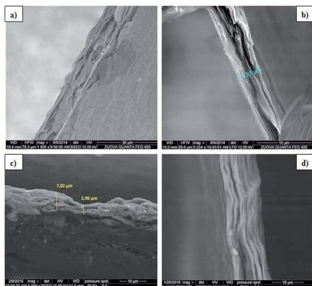
Fig. 3 SEM cuts of foils: GO (a), GO-C<sub>60</sub> (b), GO-CF (c), GO-Biochar (d)
