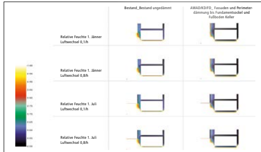
Abb. 38: Relative Feuchte (dimensionslos) für die Varianten Bestand und gedämmt im Winter bzw. Sommerfall bei unterschiedlichen Luftwechselraten bei erhöhter Durchfeuchtung des Erdreichs
