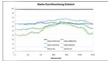
Abb. 40: Relative Feuchte (in %) im Keller bei erhöhter Durchfeuchtung des Erdreichs in Abhängigkeit von der Lüftung LW: Luftwechsel
