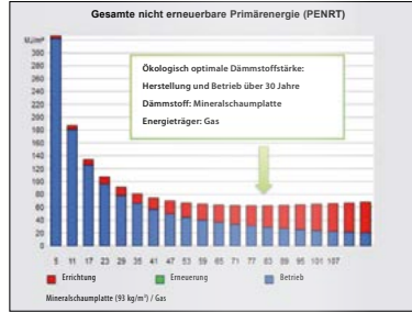
Abb. 2: Darstellung der Herstellungs- und Betriebsprimärenergie für 30 Jahre in Abhängigkeit von der Dämmstoffstärke für eine Mineralwolleplatte
